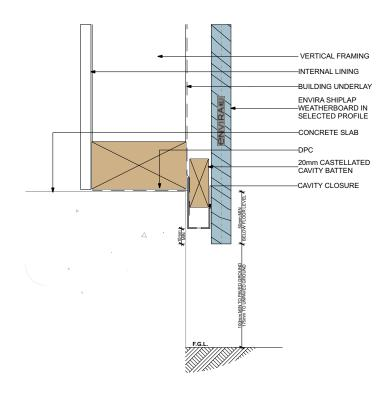
Shiplap Cavity Fix **Door Sill 6003 2D**:
